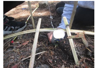
圖 1-1-1 測量彈力時電子秤的位置
